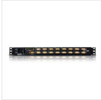
**Le commutateur KVM LCD Slideaway™ CL5716 est une unité de commande qui permet d'accéder à plusieurs ordinateurs depuis une seule console PS/2 ou USB (clavier, écran et souris). Un seul commutateur CL5716 peut commander jusqu'à 16 ordinateurs. Il est également possible de connecter en chaîne au CL5716 jusqu'à 31 commutateurs KVM supplémentaires, ce qui permet de contrôler jusqu'à 512 ordinateurs depuis une seule console KVM.**
