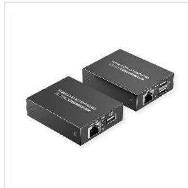
**Prolongation KVM via un câble cat.6/6A/7 jusqu'à 40 mètres de distance de la console distante (écran HDMI, clavier et souris USB) en HDMI 4K@30 Hz (jusqu'à 70 m en 1080p@60Hz). Idéal pour la publicité, les systèmes de surveillance, les conférences, mais aussi le divertissement à domicile, et bien plus encore.**
