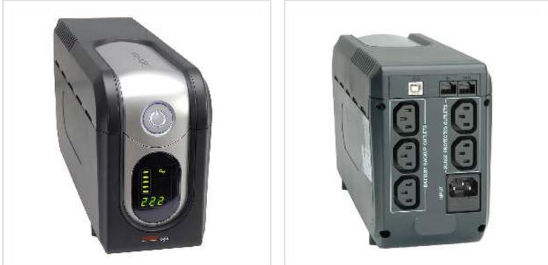
**L'onduleur ROLINE DesignSecure de technique Line Interactive est prévu pour une utilisation avec les postes de travail. Le réglage de la différence entre la tension d'entrée réelle et celle nécessaire se fait par "Buck and Boost". L'administration des batteries permet de les surveiller et de les recharger uniquement si nécessaire. Cela permet un prolongement de leur temps de vie de 50%.**
