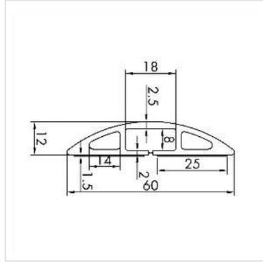
**Le pont pour câbles ne fait pas que protéger les câbles qui serpentent sur le sol, il permet également, de part sa forme, d'éviter de buter dessus. Il dispose de 1 entrée permettant de protéger les câbles pour le courant et pour les données.**
