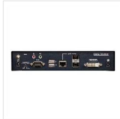
**Der KE6920 ist ein leistungsstarker IP-basierter Extender, der aus einem Sender (KE6920T) und einem Empfänger (KE6920R) besteht. Der Sender wird an einen Computer angeschlossen, um die Daten des Computers an den Empfänger zu liefern, um gemeinsam den Konsolenzugriff von einem entfernten oder separaten Ort aus zu ermöglichen.**
