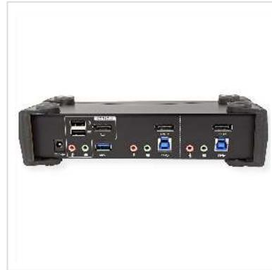
**Der ATEN CS1922 2-Port USB 3.0 4K DisplayPort KVMP™ Switch bietet die neuesten Innovationen in der Desktop KVM Switching Technologie für den zunehmenden Bedarf an höherer Videoqualität und Übertragungsgeschwindigkeiten auf modernen Computern.**
