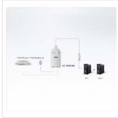
**Der UC100KMA ist ein Signalkonverter mit einem 30 cm langen Kabel. Er kann das Signal von PS/2-Geräten (Tastaturen und Mäuse) in ein USB-Signal umwandeln. Das Gerät unterstützt zahlreiche Betriebssysteme und ist so für nahezu alle Anwender flexibel einsetzbar.**
