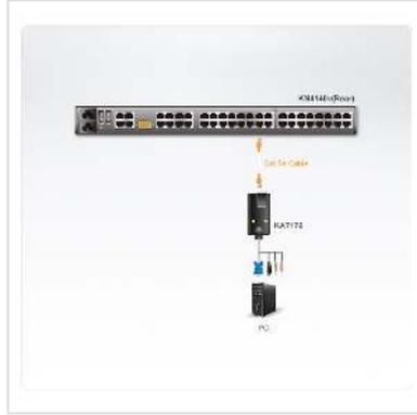
**ATEN KA7176 USB VGA-Cat5e/6 KVM-Modul VM, verbindet Ihren KVM-Switch mit den Grafik-, USB-Tastatur- und - Maus- sowie Audioanschlussbuchsen des Zielcomputers.**
