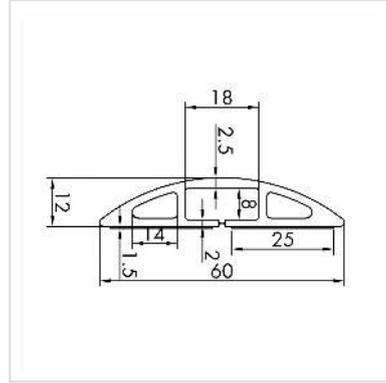
**Die Kabelbrücke deckt nicht nur die Kabel ab, die auf dem Boden liegen, sie verhindert auch Stolpern. Die Kabelbrücke verfügt über einen Kabelgang, zum Trittschutz für Daten- oder Stromversorgungskaben.**
