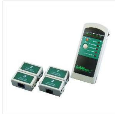
**Der LANtest Pro - Netzwerk-Kabeltester mit Tongenerator ist ein kleines handliches Testgerät, das es dem Benutzer ermöglicht, schnell den Zustand von Ethernet Twisted Pair Kabeln anzuzeigen. Es ermittelt sekundenschnell Fehler wie offene, kurzgeschlossene, gekreuzte, gedrehte Kabelpaare sowie Split Pair Fehler. Mit der Tongenerator-Funktion kann der Techniker ein Signal durch die verlegten Kabel senden und mit dem Cable Tracer dann den Fehler lokalisieren.**
