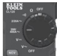
2. Schließen Sie die Zange um die Leitung herum. Die gemessene Stromstärke wird im Display angezeigt.
