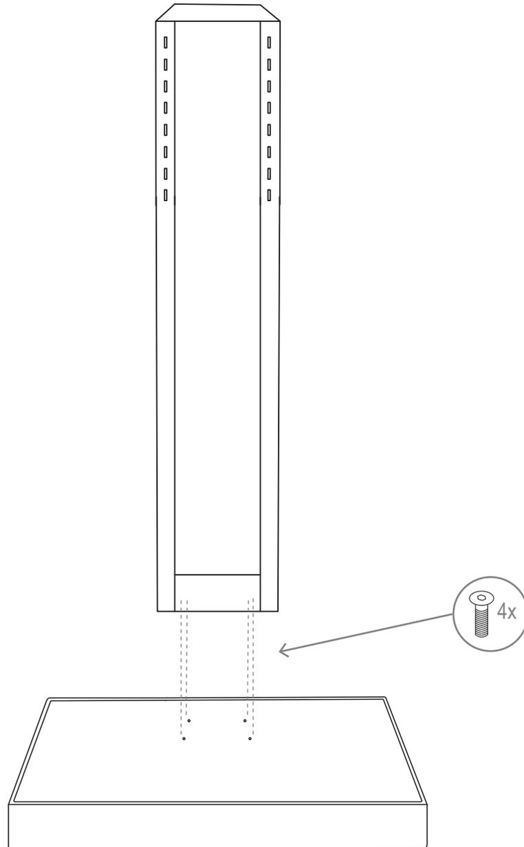
Legen Sie die Standsäule auf eine weiche Unterlage um Beschädigungen zu vermeiden. Verschrauben Sie die Bodenplatte mit der Standsäule, verwenden Sie hierfür die M8X40 Senkkopfschrauben. Richten Sie die Säule anschließend vorsichtig auf.
