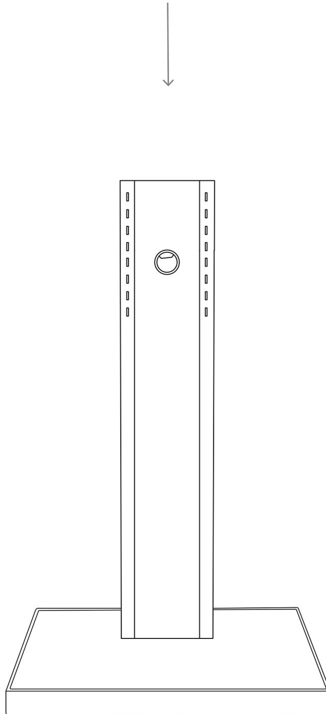
Verlegen Sie innerhalb der Säule alle benötigten Kabel und schieben Sie anschließend die Frontblende und die rückseitige Abdeckung vorsichtig von oben in die Säule ein. Vermeiden Sie es die Blenden zu verkanten um Beschädigungen zu vermeiden.
