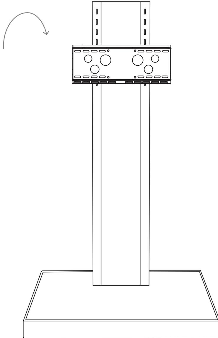
Hängen Sie die VESA-Aufnahme / VESA-Montageplatte in der gewünschten Höhe in die Raststufen der Säule ein.
